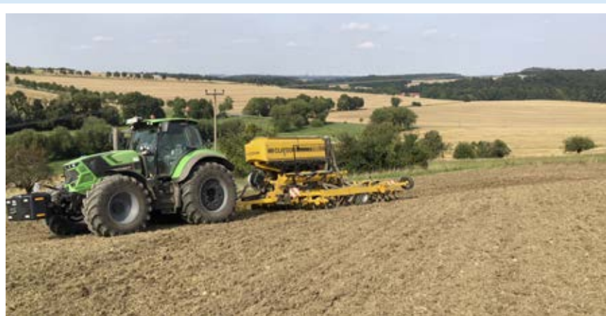
Det er en 4 meter bugseret Claydon T4 som denne, Klaus Knudsen kører med. Såmaskinen har blandt andet en grubbetand, som har været medvirkende til, at Klaus Knudsen er helt ude over problemer med erosion.
