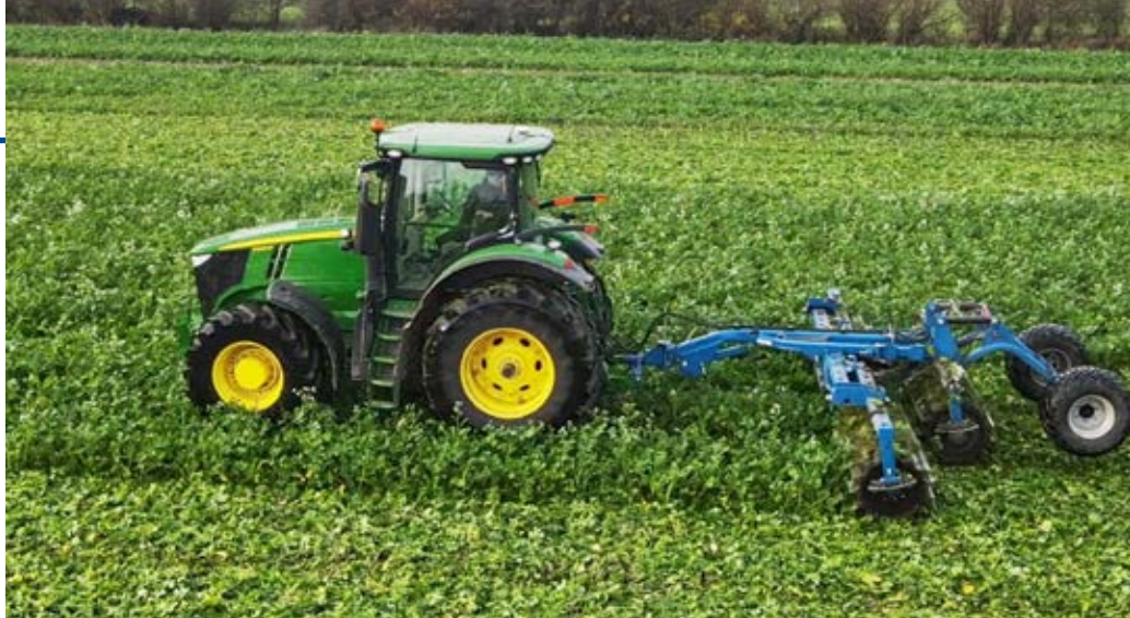
Tromling med Dalbo 6 m MaxiCut knivtromle.
