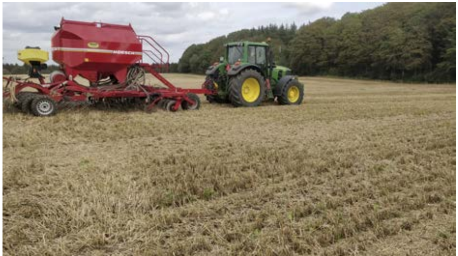
Såning af efterafgrøder ved Jacob Justesen 30. august 2019. Jacob har monteret skiver og smalle skær på sin Horsch Sprinter såmaskine. Selvom det er en tand-såmaskine, kan man næsten ikke se, hvor den har sået.
