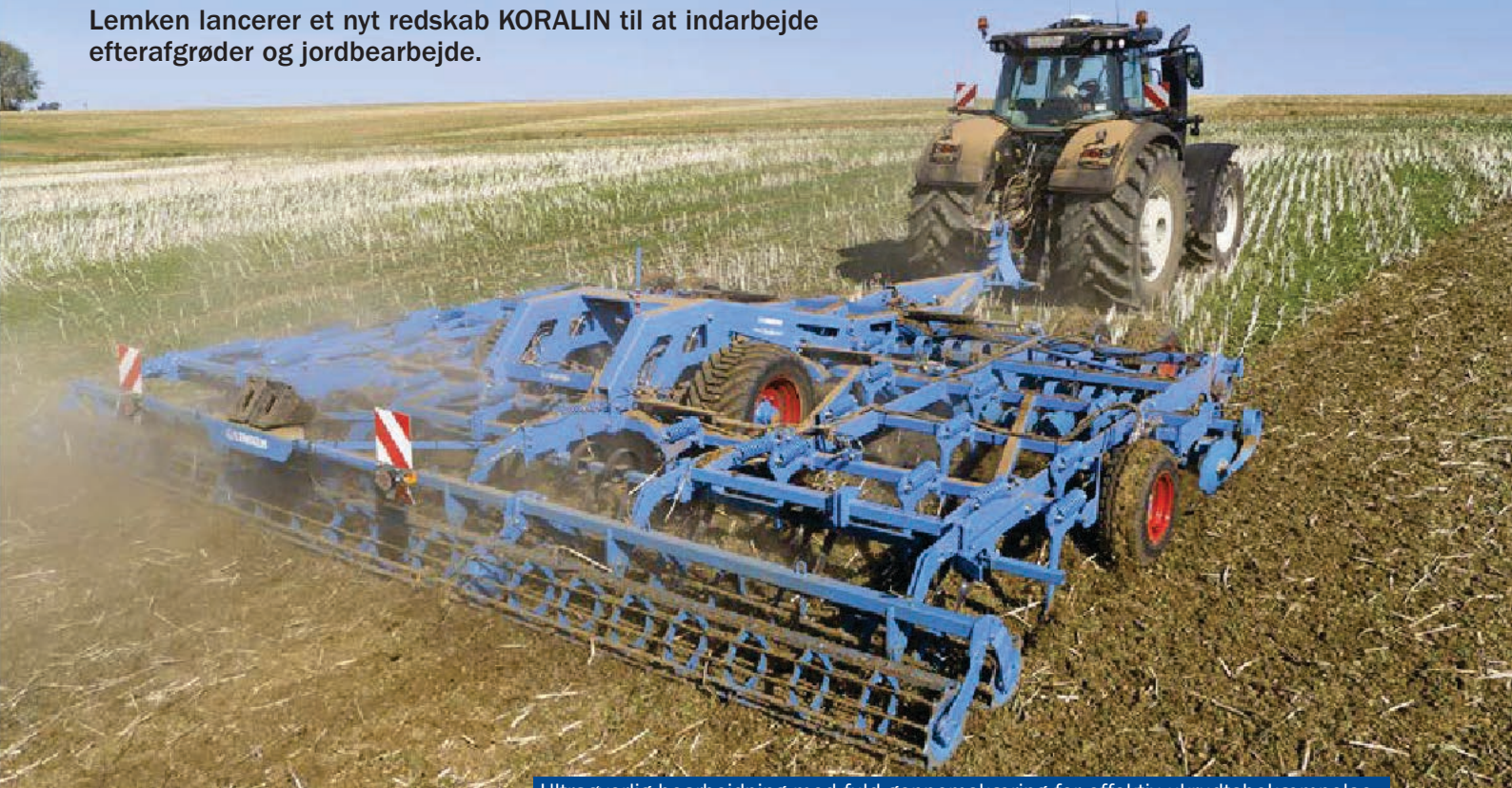
Ultraøverlig bearbejdning med fuld gennemskæring for effektiv ukrudtsbekæmpelse.
