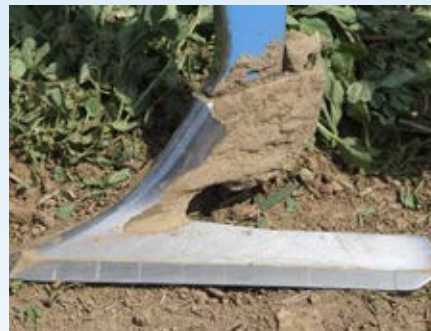
Vingskær med hårdmetalbelægning for fuld gennemskæring med 2,5 cm overlap.
