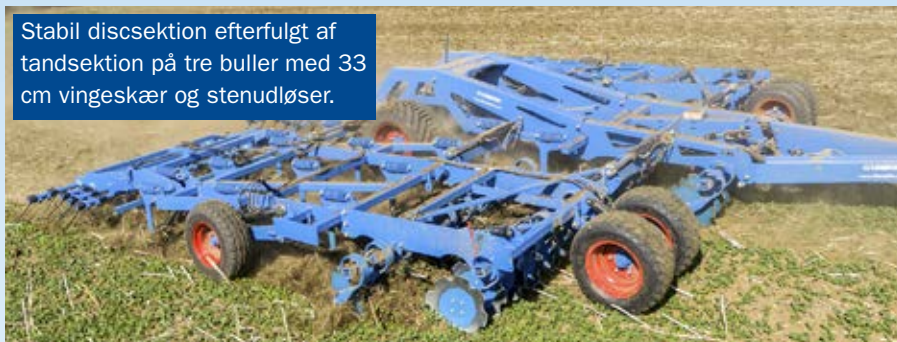
Ultraøverlig bearbejdning med fuld gennemskæring for effektiv ukrudtsbekæmpelse.
