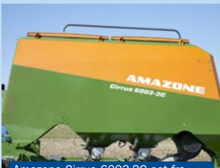
Amazone Cirrus 6003-2C set fra siden. Den har to tanke og to udmadningsenheder.
