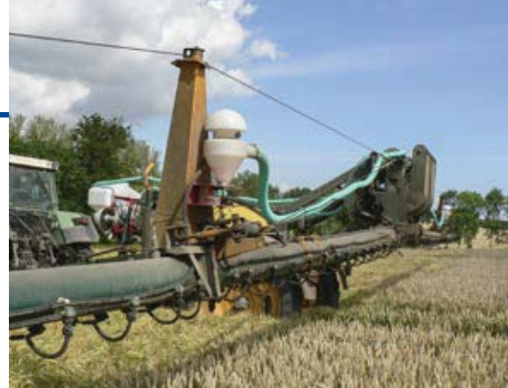
Decentral tank med ud-doseringsenhed og spredeenheder for op til 10-12 m giver god fordeling. Foto MI
