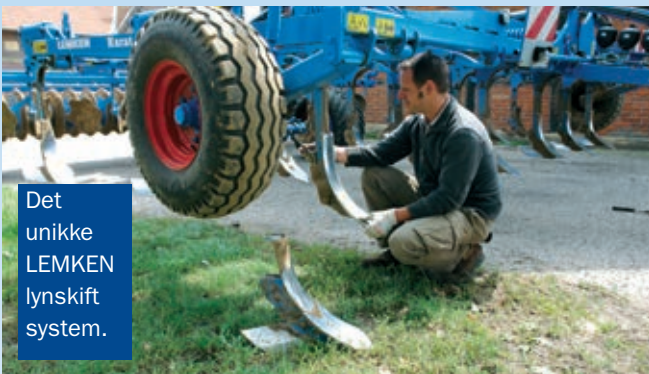
Karat kan udstyres med et stort udvalg af arbejdsværktøjer, som alle kan leveres med hårdmetal, der forlænger holdbarheden op til fire gange
