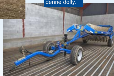
Tromlen er forbundet til harven via denne dolly.
