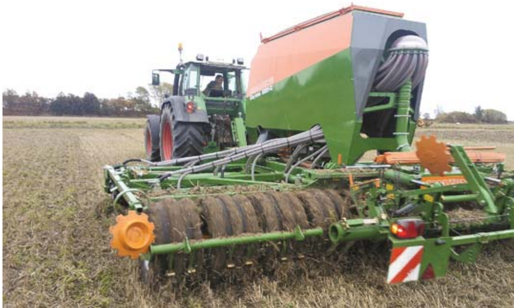
Amazone Cayena er en nyudviklet tandskærs-såmaskine til både direkte såning og såning efter harvning.
