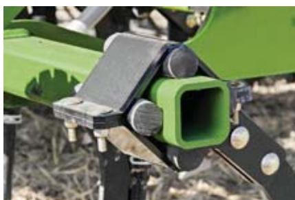
Billedet viser, hvordan såskærene er ophængt, så de kan fjedre både til siden og bagud ved påkørsel af jordfaste emner.
